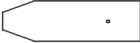
Figuur 38. Geslepen objectglas voor het maken van een bloeduitstrijkje.
